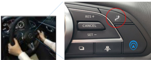
ドライバーがステアリング・スイッチを押下して承認
