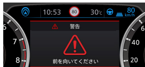
図5 ドライバーモニタによる前方注視を促す警報
