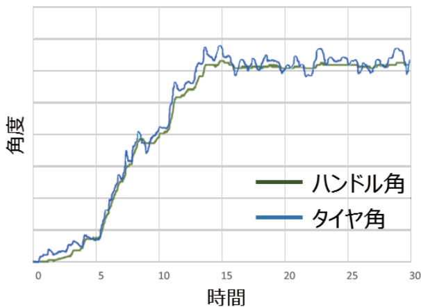
図10 ハンドル角とタイヤ角の応答性比較
