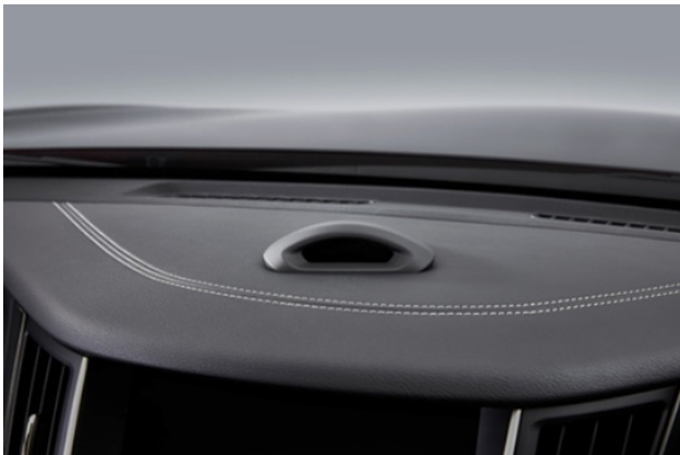
図9 ドライバーモニタの取り付け位置
