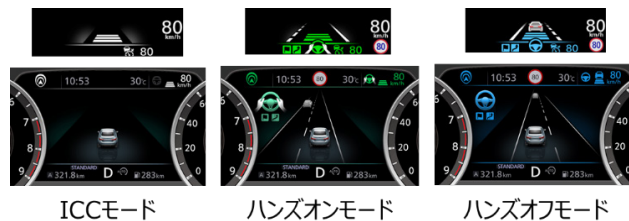
図2 作動状態を示すカラーコーディング
