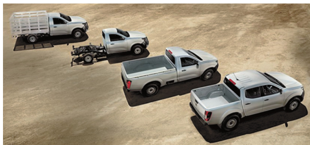
図-1 上側より架装、シャシーキャブ、シングルキャブ、ダブルキャブ Fig. 1 Customized body, chassis cab, single cab, and double cab shown from the top
