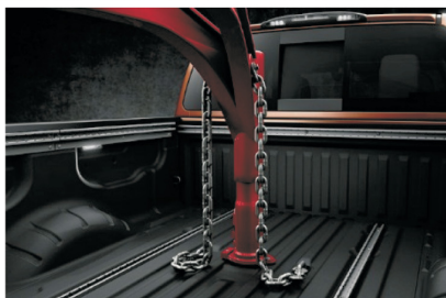
図-6 トレーラハウス（上）とゲースネック（下） Fig. 6 Trailer house and integrated gooseneck hitch
