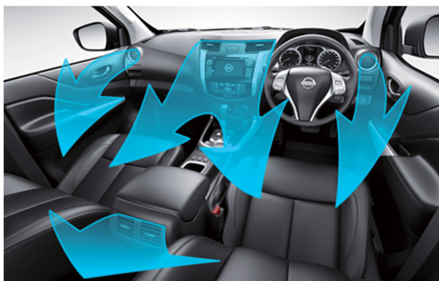
図-14 左右独立温調フルオートエアコンと後席中央エアコンベント Fig. 14 Full-automatic air conditioner with rear vents
