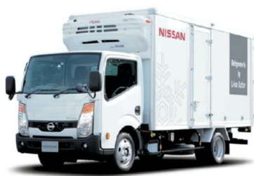
図-11 リチウムイオンバッテリー式冷蔵・冷凍車 Fig. 11 Refrigerator car with lithium-ion battery
