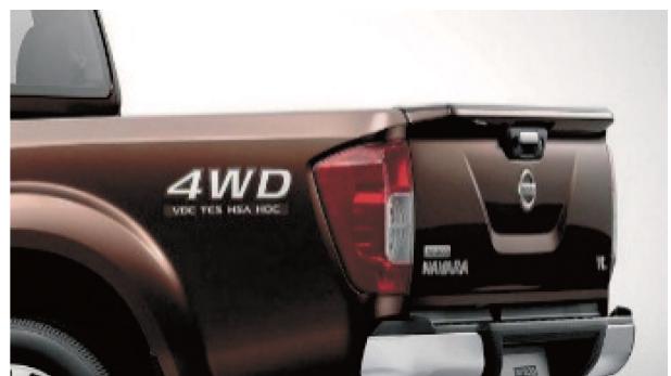
図-9 テールゲートに設定されたスポイラの採用例 Fig. 9 Example of tailgate spoiler
