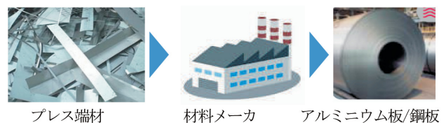
図-5 板材のリサイクルフロー Fig. 5 Recycling process in plate materials
