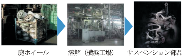
図-2 サスペンション部品へのリサイクルフロー Fig. 2 Recycling process for suspension parts
