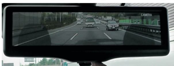
図-22 シースルー表示 Fig. 22 See-through indication image
