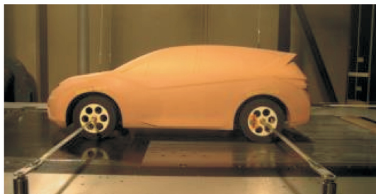
図-7 20%スケール風洞 Fig. 7 Detail of 20% scale wind tunnel
