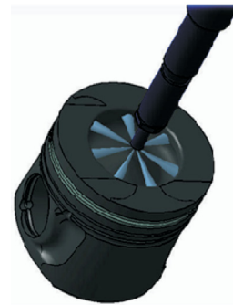
図-9 ピストン冠面形状とインジェクタ噴霧図 Fig. 9 Piston bowl and injection design
