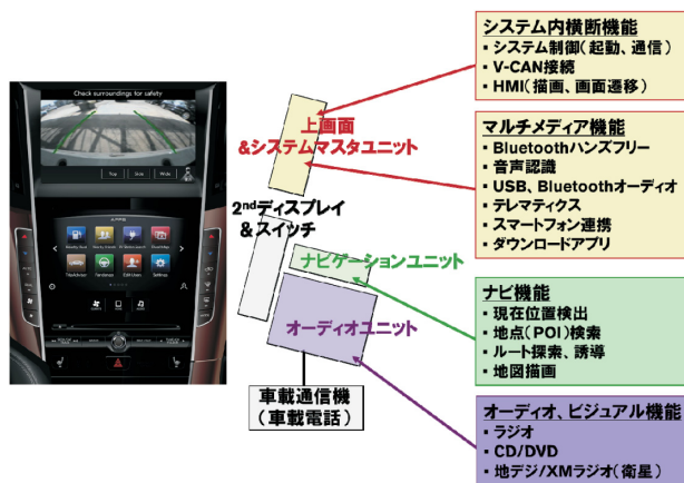
図-8 車載機の構造 Fig. 8 Onboard hardware structure
