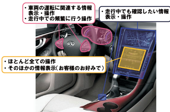
図-3 表示・操作の考え方 Fig. 3 Displays and controllers location principle
