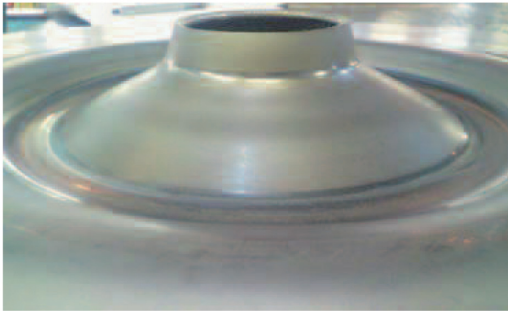
図-6 バーリング形成後のパネル形状 Fig. 6 Panel shape after the barring formation
