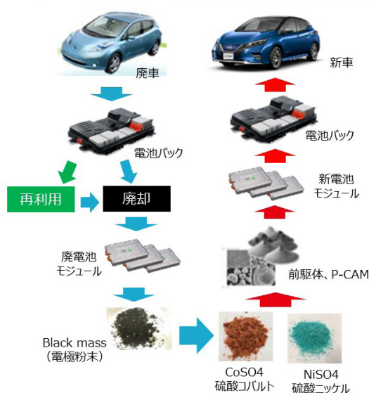
図3 バッテリー材料の循環利用
