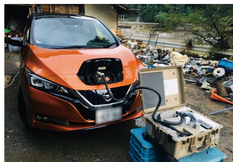
図3 日産リーフからの電力供給の様子
