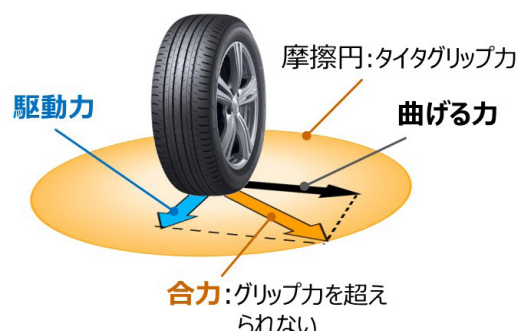
図2 タイヤグリップ力と駆動力
