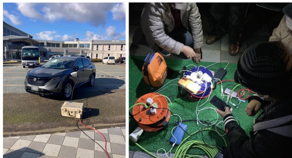
図4 日産アリアからの電力供給の様子
