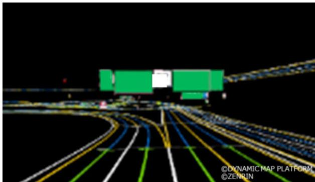
図6 3D高精度地図(3D HDマップ)
