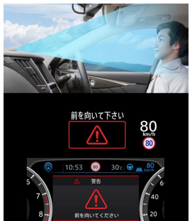
図12 ドライバーモニタによる前方注視を促す警報
