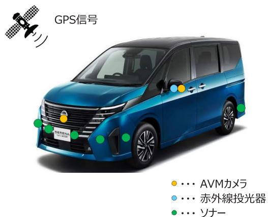
図4 メモリー付きプロパイロットパーキングの部品構成
