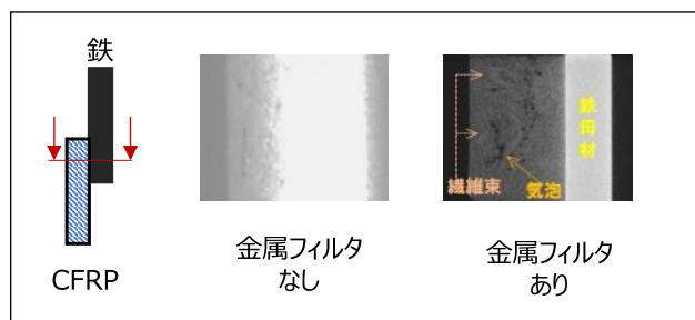
図11 鉄とCFRP接着試験品のCT画像
