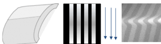
図7 キャラクターラインと縞パターン方向による縞画像の違い
