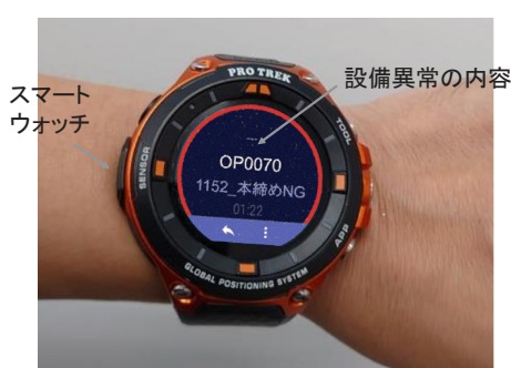
図3 設備異常を通知するスマートウォッチ
