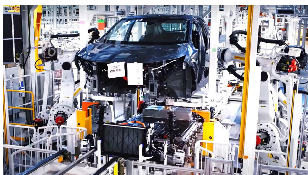
図4 パワートレイン一括搭載システム
