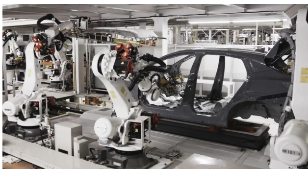
図8 ヘッドライニング自動組付け
