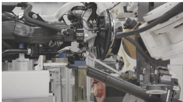
図6 サスペンションリンクの自動締付け&自動アライメント調整
