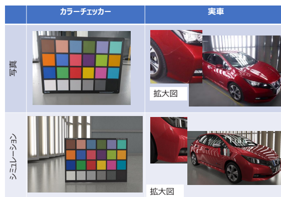
図12 色味評価:実写vsシミュレーション
