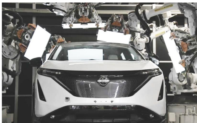
図7 統合自動検査(仕様&傷検査)
