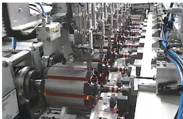
図5 磁石レス界磁モーターの巻線自動化
