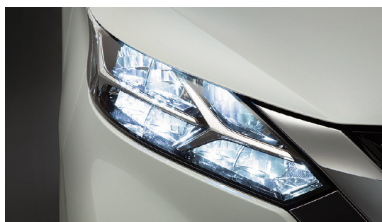
図-4 7眼マルチレフタイプLEDヘッドランプ Fig. 4 7-multi-reflector LED headlamp
