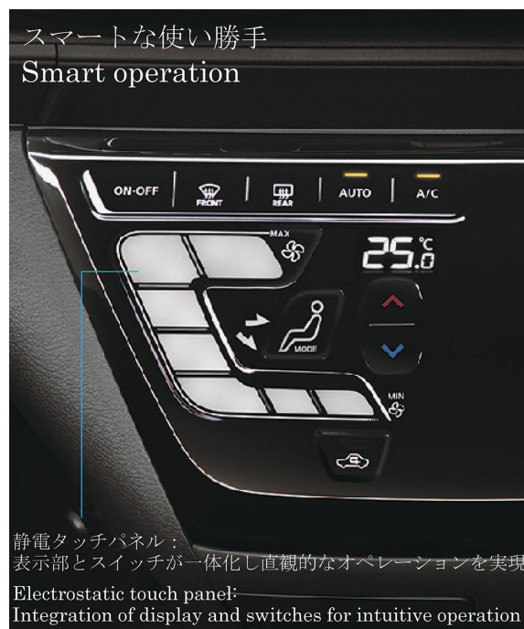
図-6 静電タッチパネル式オートエアコン Fig. 6 Electrostatic touch panel
