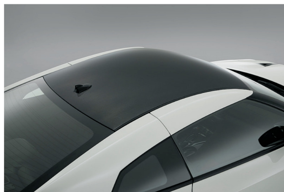
図-12 CFRPサンドイッチ材料製ルーフ Fig. 12 CFRP sandwich material roof
