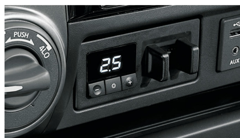
図-7 統合トレーラブレーキ制御スイッチ Fig. 7 Integrated trailer brake controller
