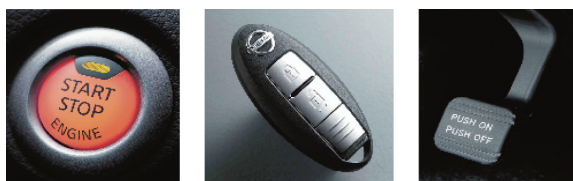
図-17 採用している先進装備 (左からプッシュエンジンスタター、インテリジェントキー、足踏み式パーキングブレーキ)
