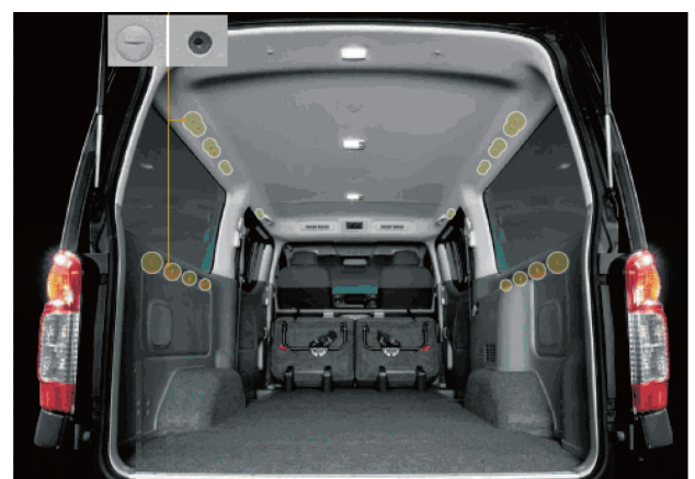
図-16 ラゲッジユーティリティナット取付け位置（黄色部） Fig. 16 Locations of luggage utility nuts (yellow parts)
