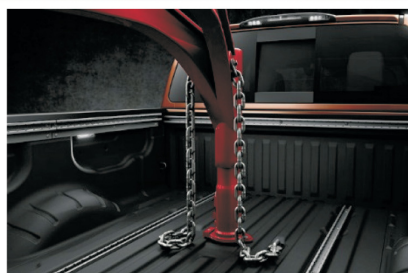
図-6 トレーラハウス（上）とグースネック（下） Fig. 6 Trailer house and integrated gooseneck hitch
