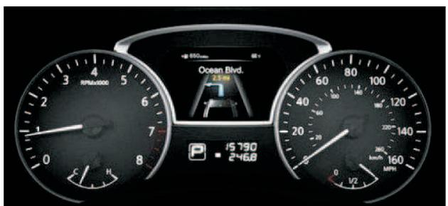
図-14 情報表示メータの例 (Maxima)
