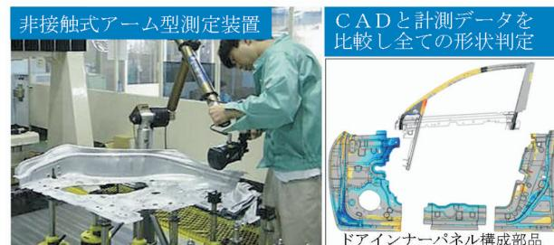
図-1 3次元形状計測装置と解析事例
