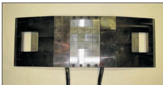
図-3 タイヤ接地面反力センサ
