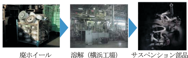
図-2 サスペンション部品へのリサイクルフロー Fig. 2 Recycling process for suspension parts
