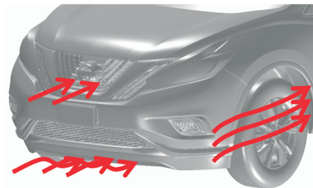
図-3 フロントエンドの理想的な流れ Fig. 3 Ideal flow of front end
