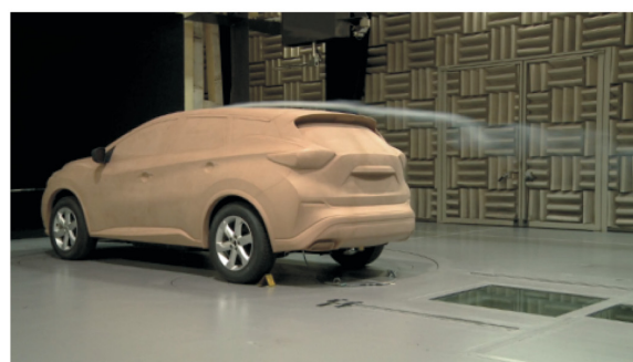
図-8 フルスケール実車風洞 Fig. 8 Detail of full scale wind tunnel
