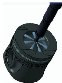
図-9 ピストン冠面形状とインジェクタ噴霧図 Fig. 9 Piston bowl and injection design
