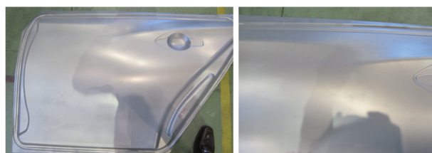
図-65 リヤドアアウター試作型での検証例 Fig. 65 Study on rear door prototyping
