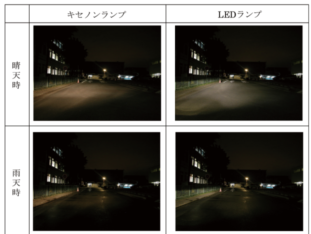
図-40 キセノンランプとLEDランプの視認性比較
