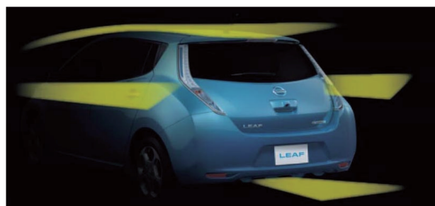
図5 車両後部デザインと整流効果
