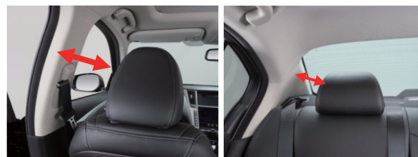
フロントヘッドレスト リヤヘッドレスト、ピラー 図-18 ヘッドレストの細型化による視界の連続性確保 Fig. 18 Example of visual continuity
