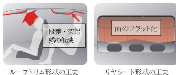
ルーフトリム形状の工夫 リヤシート形状の工夫 図-19 空間の広がり・連続性の確保のポイント Fig. 19 Key points of space continuity
