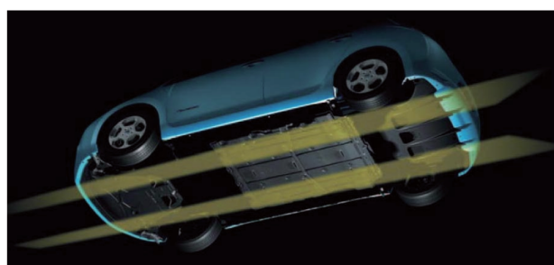
図6 車両下面デザインと整流効果
