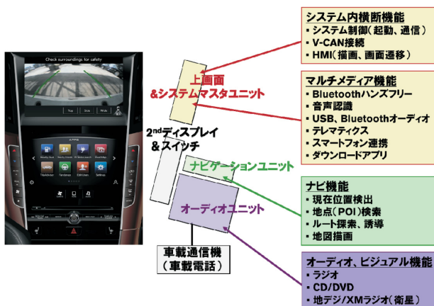
図-8 車載機の構造 Fig. 8 Onboard hardware structure
