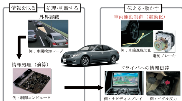
図-7 車載 IT による情報処理プロセス Fig. 7 Information processing with in-vehicle IT
