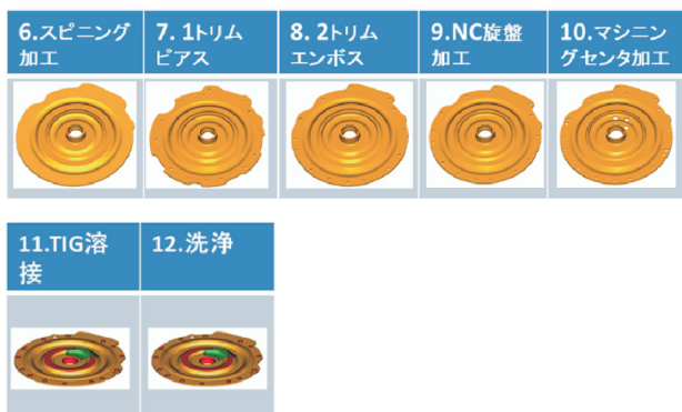
図-7 フロントカバー生産工程2 Fig. 7 Process of manufacturing front cover No. 2
