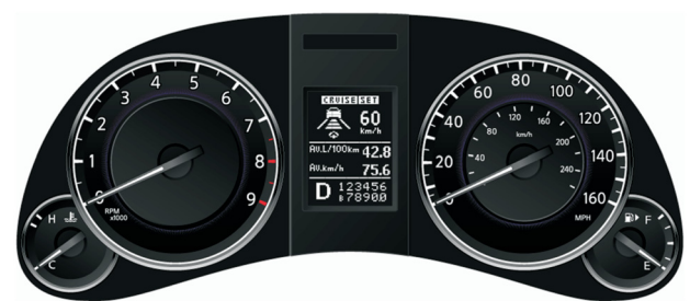
図-5 Infiniti JX 搭載のアドバンスド・ドライブアシスト・ディスプレイ付メーター Fig. 5 Infiniti JX cluster meter with Advanced Drive-Assist Display
