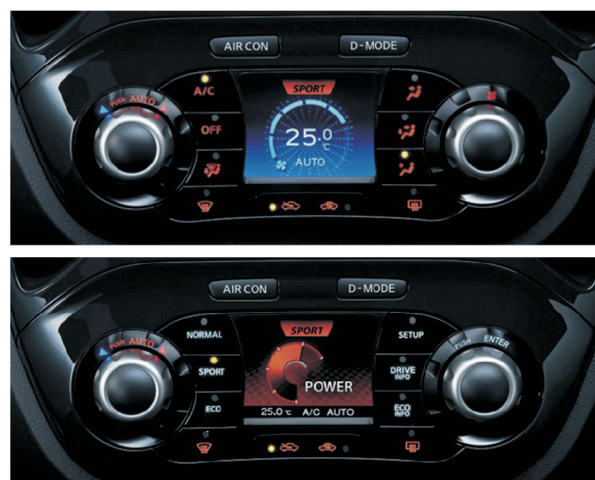
図-3 日産ジューク搭載インテリジェントコントロールディスプレイ (上段がエアコン操作時、下段がドライブモード操作時) Fig. 3 Intelligent Control Display
