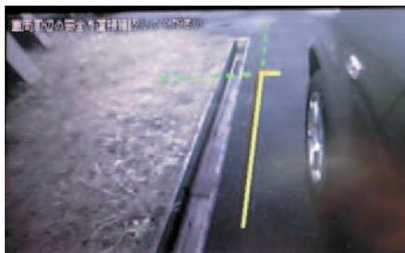
図-2 サイドブラインドモニター Fig. 2 Side blind monitor
