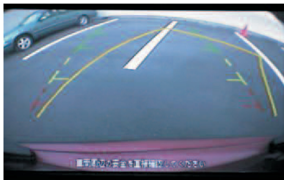
図-1 リヤビューモニター Fig. 1 Rear view monitor
