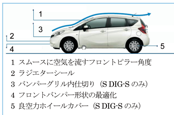
図-7 空力抵抗低減のための技術 Fig. 7 Aero dynamics
