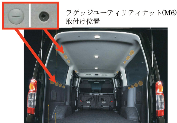
図-6 広くて使い勝手のよい荷室空間およびラゲッジユーティリティナット（M6）取付け位置 Fig. 6 Spacious, user-friendly cargo space and luggage utility nuts (M6)
