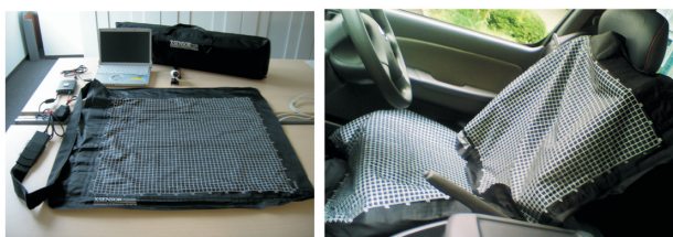
図-8 シート動的な面圧計測装置 Fig. 8 Dynamic seat pressure distribution sensor
