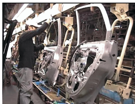
図-4 複雑な部品取付け軌跡を持つ組立作業例 (ドアガラス取付け)
