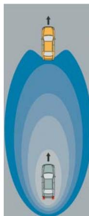
ドライバーがアクセルを戻したときに、システムがブレーキを作動させ、ドライバーが車間距離を維持することを支援する
