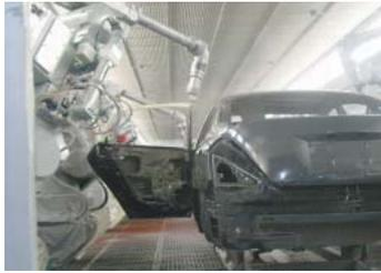
揮発性有機化合物 (VOC) が少ない水系塗装ラインへの切り替え (九州工場)
