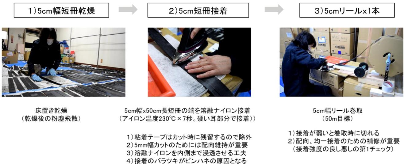
図 21 工程 2 接合工程実作業
