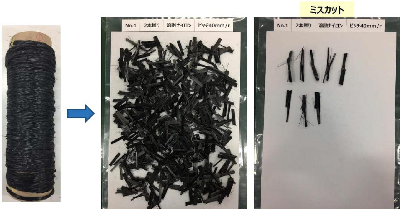
図 9 カットテスト結果 撚糸タイプ No.1: 2 本撚り、溶融ナイロン接合、ピッチ 40mm/r
