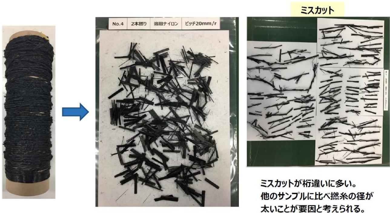
図 12 カットテスト結果 燃糸タイプ No.4 :2 本撚り、熔融ナイロン接合、ピッチ 20mm/r
