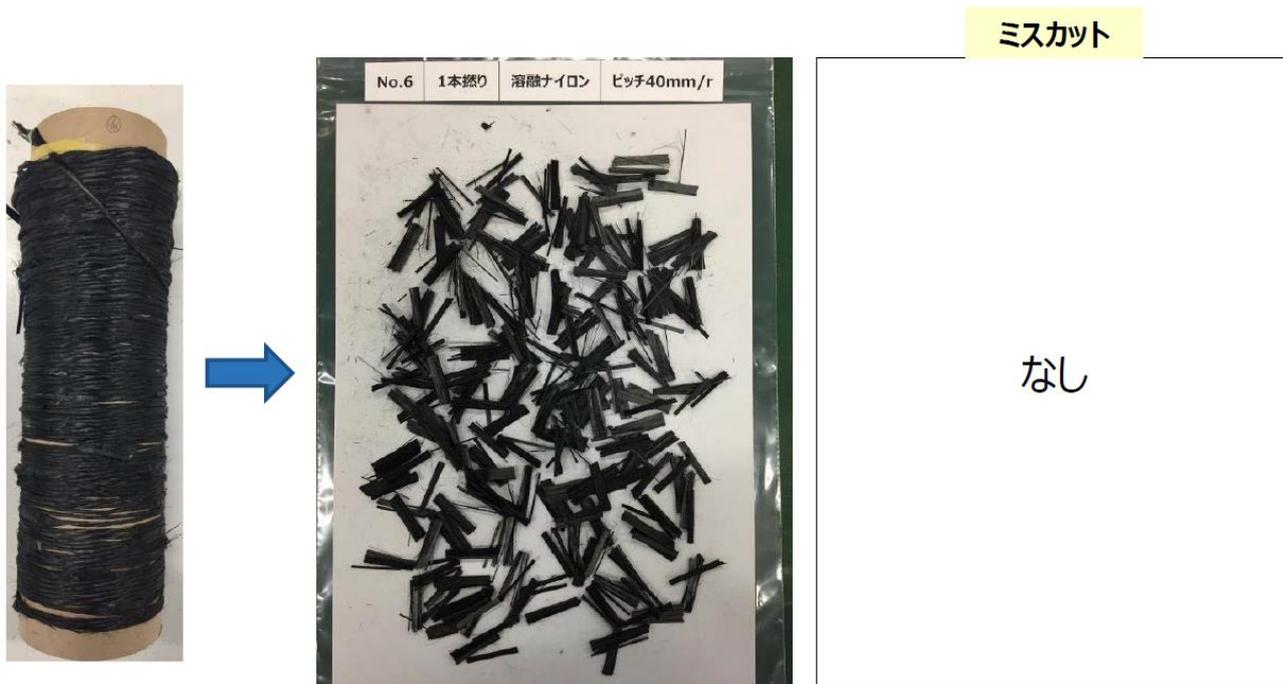
図 14 カットテスト結果 撚糸タイプ No.6: 1 本撚り、熔融ナイロン接合、ピッチ 40mm/r
