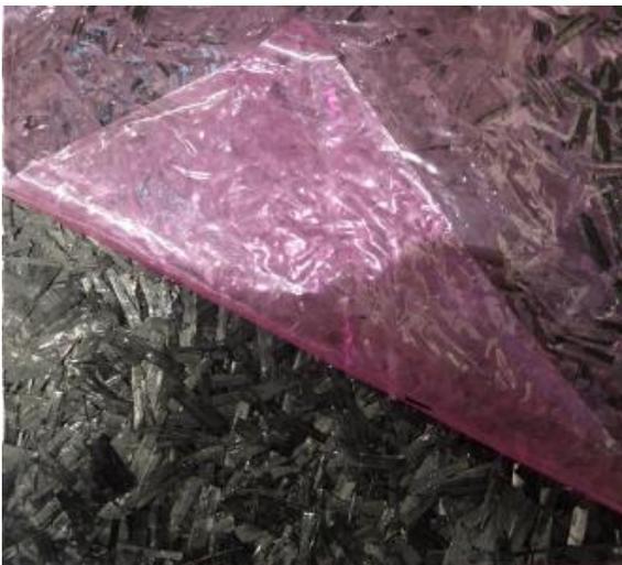
図 V リサイクル燃糸 SMC 成形板
