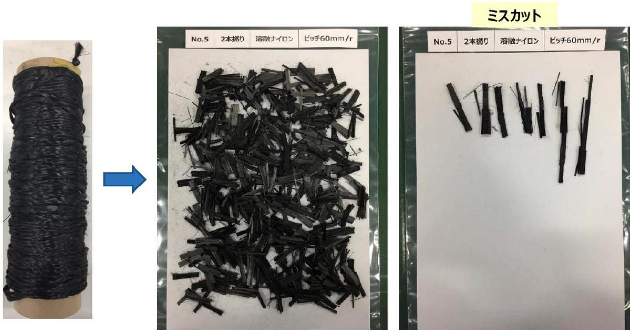
図 13 カットテスト結果 燃糸タイプ No.5: 2 本撚り、熔融ナイロン接合、ピッチ 60mm/r
