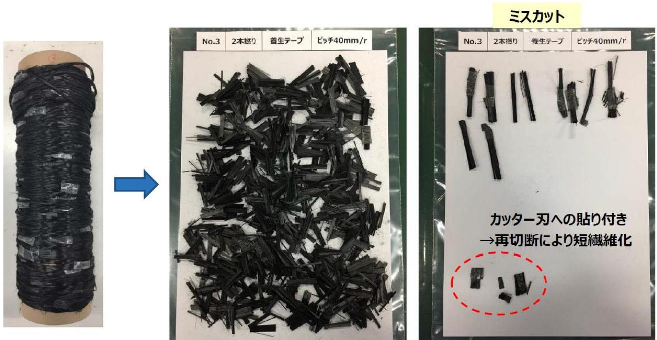
図 11 カットテスト結果 撚糸タイプ No.3: 2 本撚り、養生テープ接合、ピッチ 40mm/r
