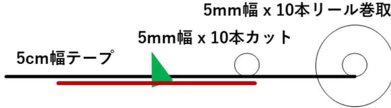
図 23 B 案のカット工程(手動開織後カットを採用)
