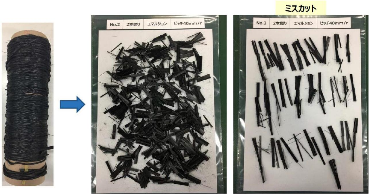
図 10 カットテスト結果 撚糸タイプ No.2: 2 本撚り、エマルジョン接合、ピッチ 40mm/r
