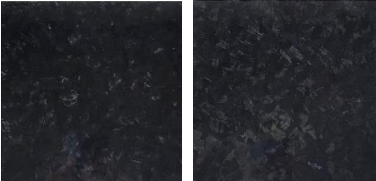
図 29 (左)SMC 市販品成形板、(右)リサイクル撚糸 SMC 成形板
