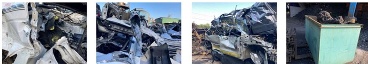
図 4-2. シート除去済みの解体自動車及び破碎後の ASR
