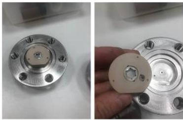
図7 耐圧テストセル
