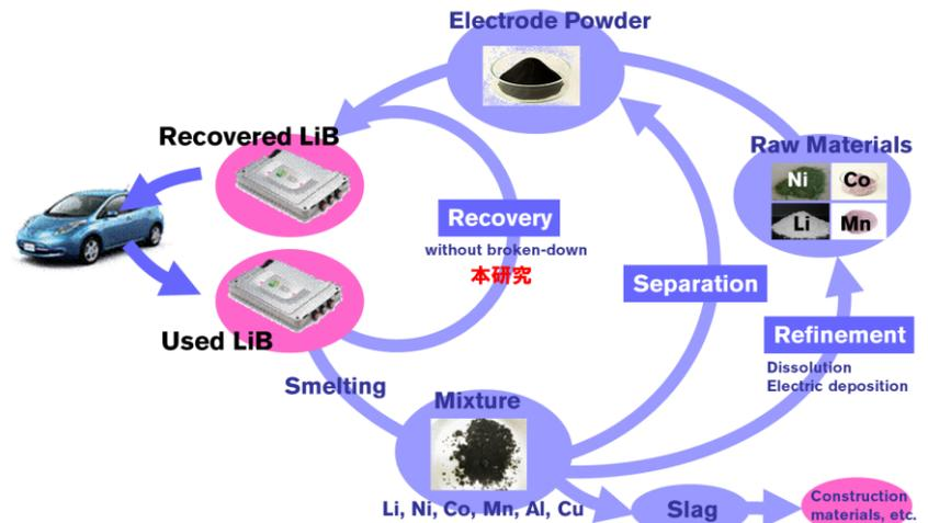
図1 バッテリーリサイクルの流れ
