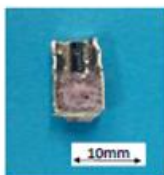
図 2-6 CaB 2 O 4 フラックスを用いた試料の断面、反射電子線像、XRD 結果 (1300℃)
