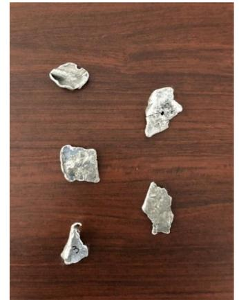
大きさの影響調査 塗装面積割合が同じ（約70%）で大きさを変えた板状アルミ（サイズ 大 中 小 各5枚）
