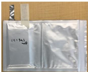
正極 :  $\text{LiNi}_{1/3}\text{Mn}_{1/3}\text{Co}_{1/3}\text{O}_2$  : AB : PVDF
