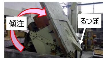
図1. 実験で用いた100kg溶解炉
