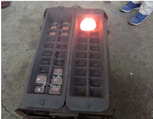
レアアースを含むスラグ相（左下） レアアースが分離された鉄相（右上）
