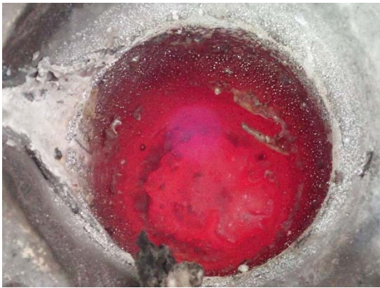
傾注後のルツボ内の様子 溶湯との反応はほとんど無い
