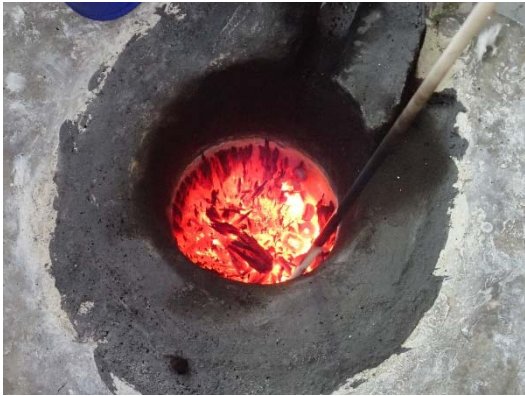
昇温開始、酸化鉄と \text{Na}_2\text{B}_4\text{O}_7 フラックスを投入
