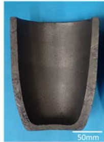
20kg溶解炉黒鉛ルツボ
