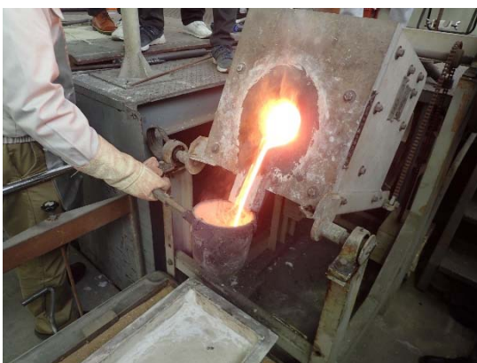
傾注によるスラグと溶融鉄の拔出し
