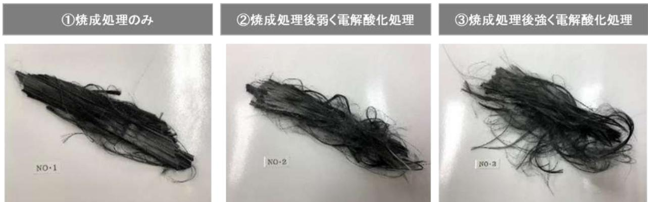
図 31 電解酸化法で取り出したリサイクル CF 外観
