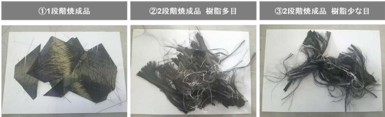
図 29 2 段階熱分解法で取り出したリサイクル CF 外観
