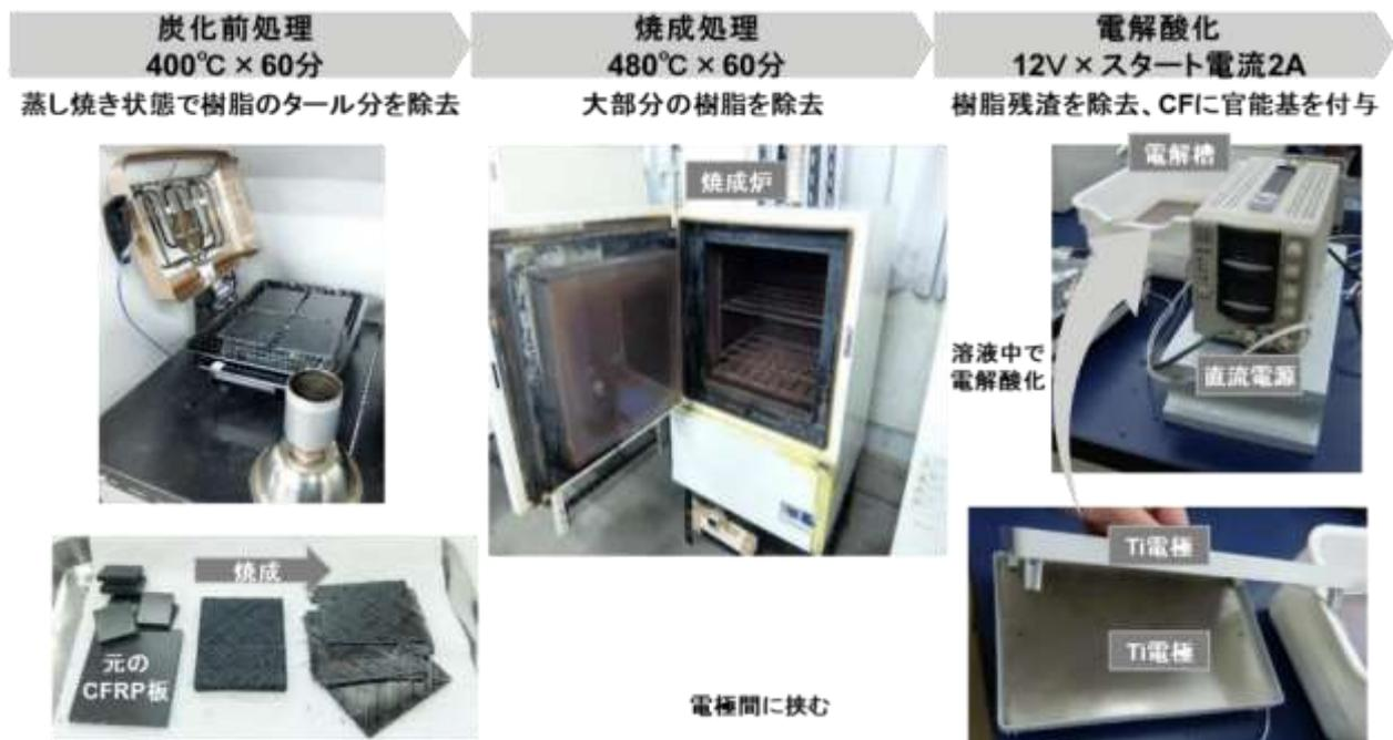
図 27 電解酸化法の装置外観写真
