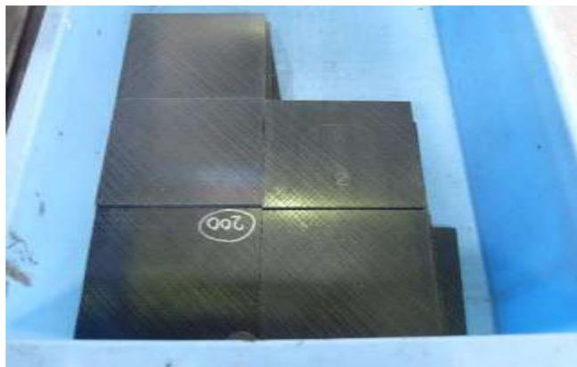
図 15 110mm x 100mm x 4mm のサイズに切断した平板の外観写真
