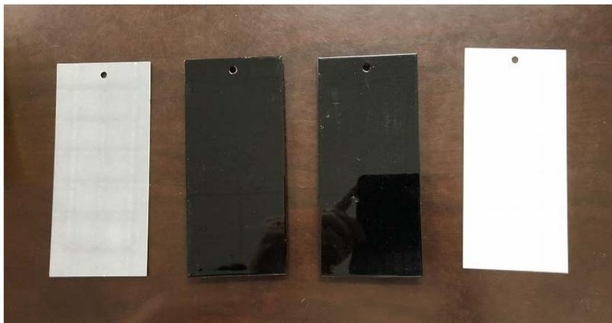
写真1: 試料外観1(左から 電着塗装のみ、塗装黒薄塗り、塗装黒厚塗り、塗装白パール薄塗り)
