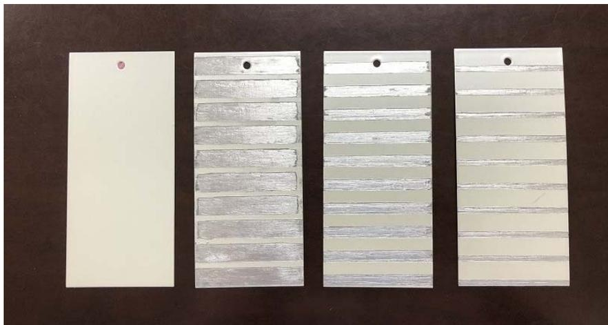
写真2: 試料外観2 (左から 塗装白パール厚塗り、塗装白パール厚塗り塗装面積25%、50%、75%)
