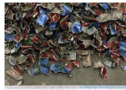
破碎後のアルミニウムスクラップ
