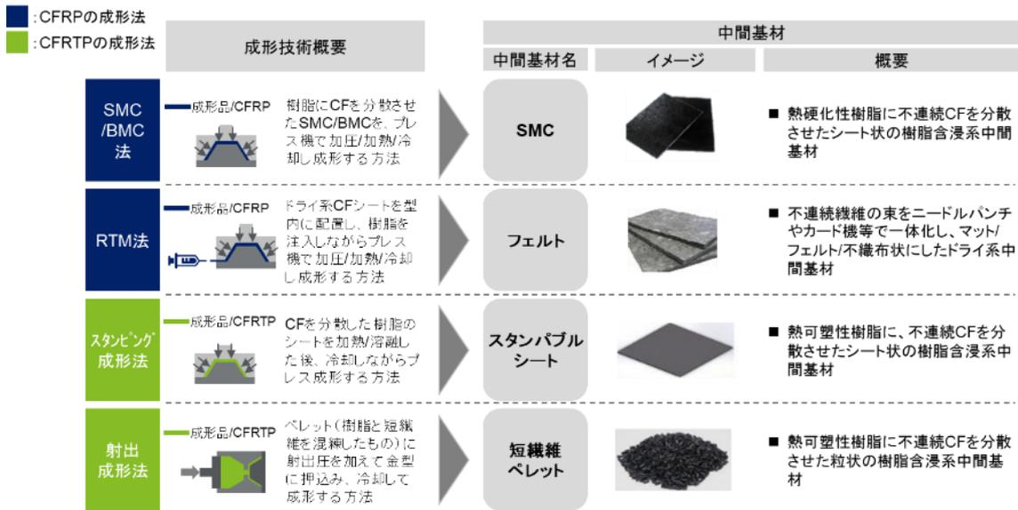
図 14 不連続繊維系における4つの有望成形法に対応する中間基材
