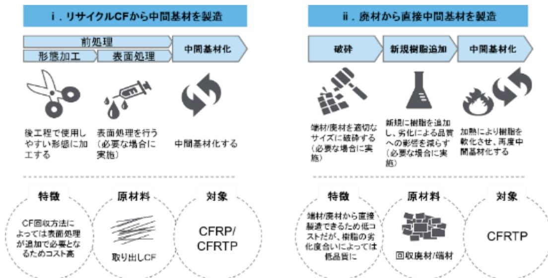
図 15 CFRP/CFRTPの廃材/端材から取り出したCFから中間基材を製造する方法
