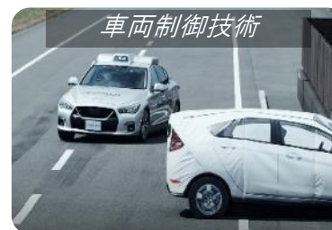
世界初のステアリングによる回避機能を搭載した 空間認知車両制御技術 (Ground Truth Perception)
