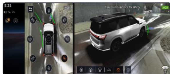
インテリジェントアラウンドビューモニター (2025年モデルイヤー QX80より) 3次元表示+ フード透過表示
