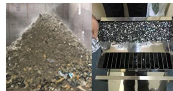
写真左：ASR、写真右：ASR から回収された樹脂
