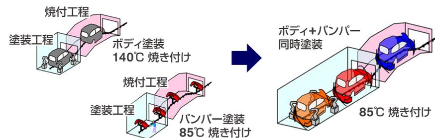
従来2つあった工程（左図）を、新技術でボディ・バンパーを同時に塗装し1つ（右図）に集約することと低温（85°C）で乾燥させることでCO<sub>2</sub>排出量を削減した。
