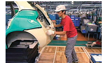
日産生産方式「ストライクゾーン」 改善前（写真上）：作業者がしゃがんだ姿勢で部品を取り付ける
