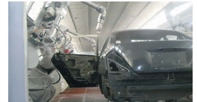
揮発性有機化合物（VOC）が少ない水系塗装ラインへの切り替え（九州工場）
