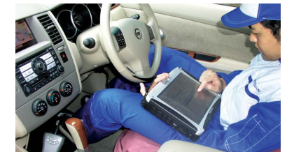
高性能化するクルマの不具合を「CONSULT-Ⅲ」で的確に診断
