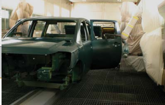
揮発性有機化合物（VOC）の少ない水系塗装を採用しているキャントン工場（米国）
