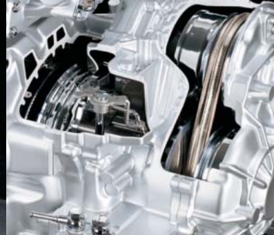
CVTは、変速ショックがなく、無段階に連続的に変速するため、スムーズなレスポンスと力強い走りが楽しめるとともに、低燃費で環境にもすぐれた変速機
