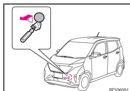
3. 金属の固い棒などを使用して、けん引フックを取り付ける。
