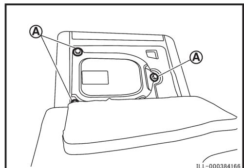
参考：ボルトを外せない、又は外す工具がない場合は、バールを図の位置に引っ掛け持ち上げることで点検ホールカバーを取り外すことが出来る。
