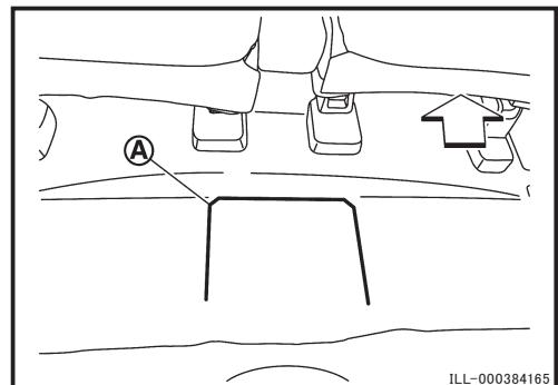
3) 取付ボルトⒶを取り外し、点検ホールカバーを取り外す。
