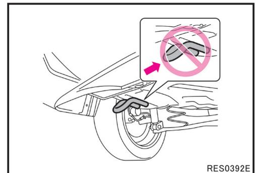
トレーラーなどで輸送するときは、車両下側のスロット穴とタイダウンフックを使い固定してください。
