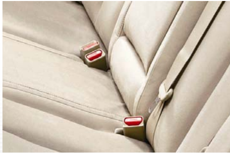
後席シートベルト自立バックル 差込口が分かり易く、装着しやすいように自立させたシートベルトバックル
