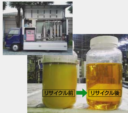
部品加工洗浄液のリサイクル装置を 搭載した車両(上) リサイクル処理前後の部品加工洗浄液(下)
